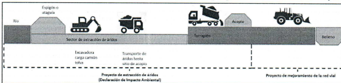
Figura II-7. Esquema del proceso de extracción de arenas y depósito en los sectores de acopio
